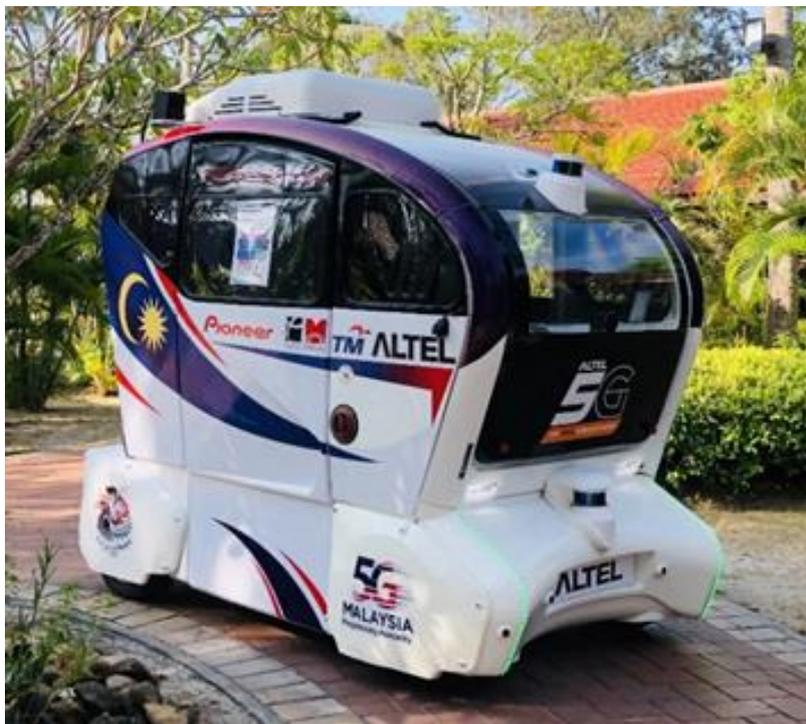
【PSSIの「3D-LiDAR センサー」が搭載された自動運転シャトルバス】
