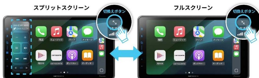
・ ハードキーには、ディスプレイと一体化し、指先で軽くタッチするだけで操作できる静電タイプのフラットキーを採用。どの画面からでもダイレクトに「Apple CarPlay」「Android Auto」画面へ遷移できるキーを配置するなど、シンプルで使いやすいインターフェースを実現しています。
