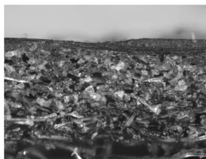
【2層構造開繊カーボン振動板の断面図】
