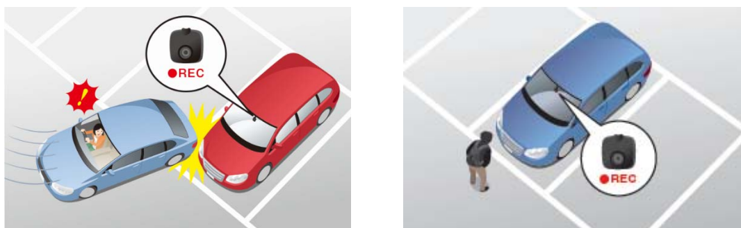
【G センサーとモーションセンサーで衝撃や動体を検知すると前方の風景を自動録画】
