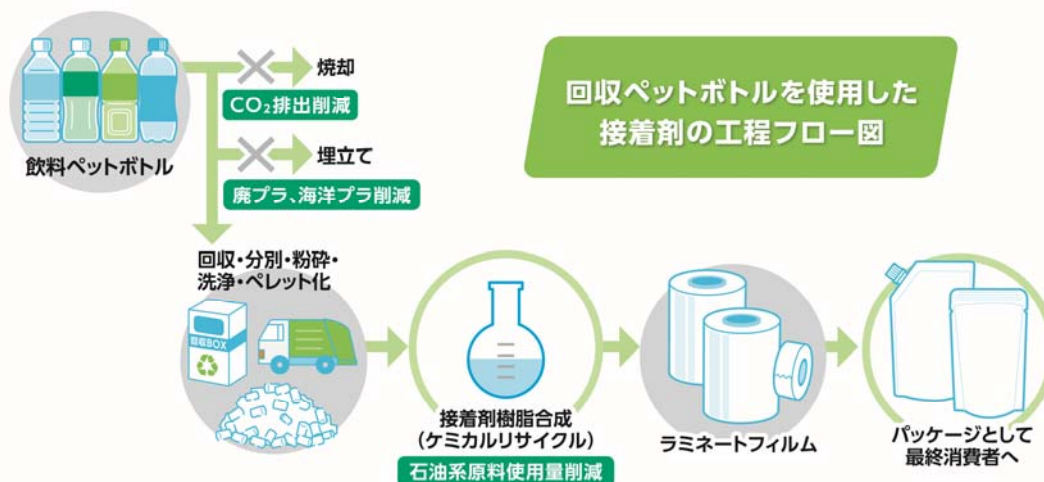
回収ペットボトルを使用した接着剤の工程フロー図
