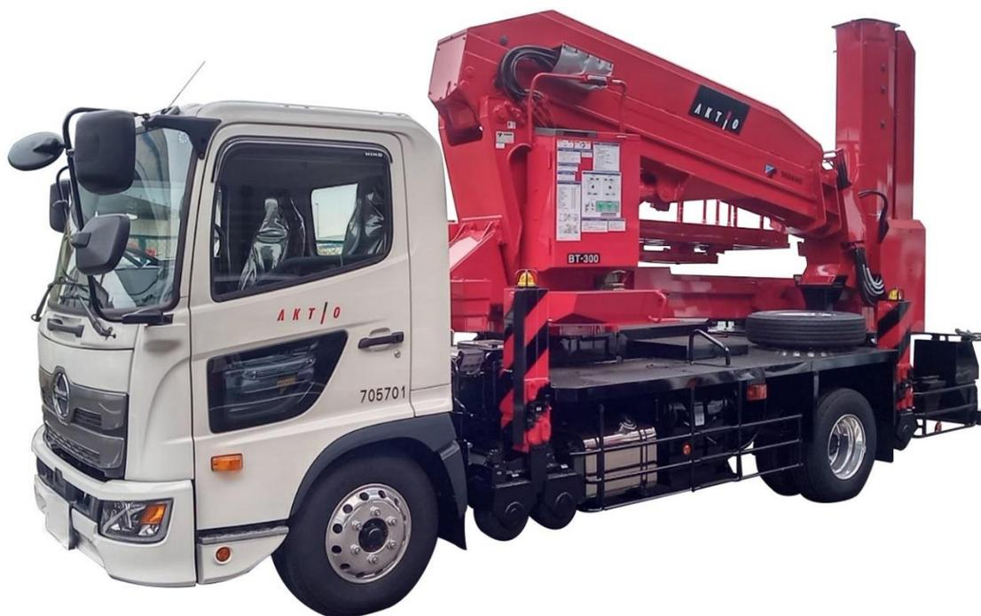
中型橋梁点検車「BT-300」の最大の特徴は、橋梁点検の際にブームを左右両側に展開できる点です。これまでのBTシリーズでは、車両左側のブーム展開のみで、車両右側の作業を行うことができませんでした。今回の「BT-300」は、一方通行の高速道路や自動車専用道路の追い越し車線側から桁下アプローチが可能となります。また、デッキ最大差し込み長さは8.7mで、デッキ本体は180度旋回が可能のため作業領域が広く、効率的な作業ができます。
