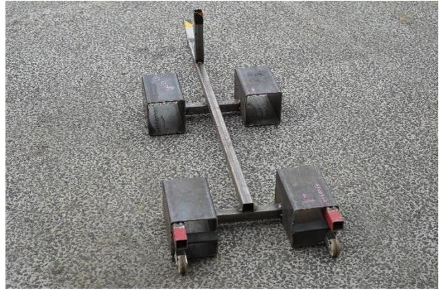
今回作成した台車は、北越工業株式会社の高所作業車 ENCL・ENTL シリーズに対応した専用台車です。高所作業車の車体下部に合わせて4つの鉄製の台がつながった仕様で、クレーンで吊った車体の下に片手でスライドして差し込み、ストッパーが車体に触れたところで車体を降ろせば位置が合うようになっています。安全性の向上とともに、時間も従来の半分以下になり、効率化を実現しました。また、台車自体が重いので、持ち運びがしやすいよう車輪もつけました。
