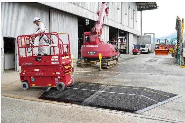
一方に通過するだけで、前傾斜・後傾斜・横傾斜の点検ができる。工場内の高所作業車の「通り道」に設置することで、常時、効率的な点検が可能となった。
