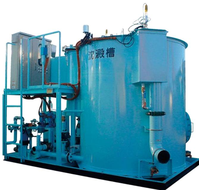
濁水処理とは、工事現場などで発生する工業用排水を一般的な生活排水路へ流せるように、pH値・水質などを調整して浄化させる作業です。濁水処理装置では、泥を含んだ工業用排水に凝集剤(特殊な粒子が入った薬液)を混入させ、水中の不純物とこの薬液が反応して大きな塊に結合することにより、自重で沈降させ、水と不純物をタンク内で分離させることができます。
