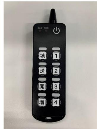
写真3 無線電子雷管通信のタブレット PC 写真4 装填装置用のワイヤレス操作リモコン
