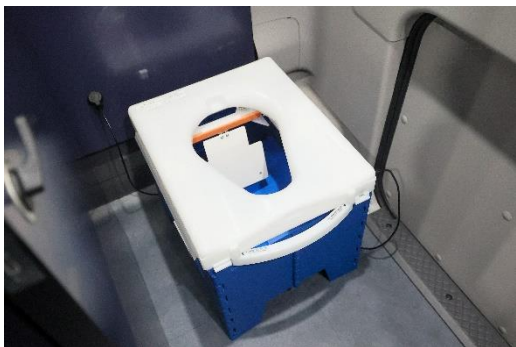
ラップポントイレ
