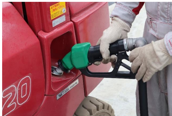
バイオディーゼル燃料をフォークリフトに給油している様子
