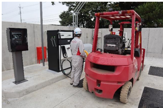
バイオディーゼル燃料をフォークリフトに給油している様子
