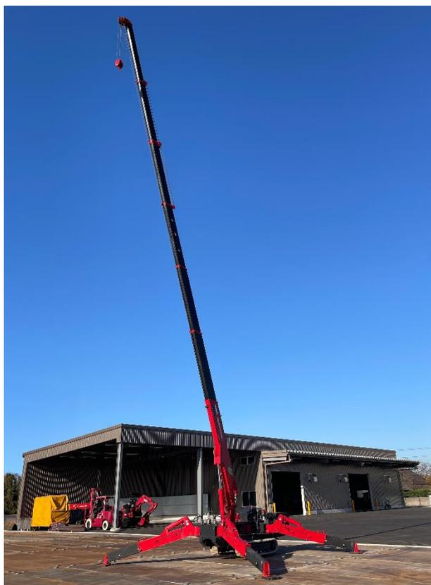
「移動式クレーン URW507C」は、環境への配慮と作業効率を両立させた機械です。電動パワーユニット併用仕様で、ディーゼルエンジンと電動モーターの切り替えも容易なため、多様な作業環境に柔軟に対応します。電動モーター使用時は、排気ガスゼロでエンジン騒音もないので、夜間の市街地や屋内での作業、都市部での使用に最適です。
