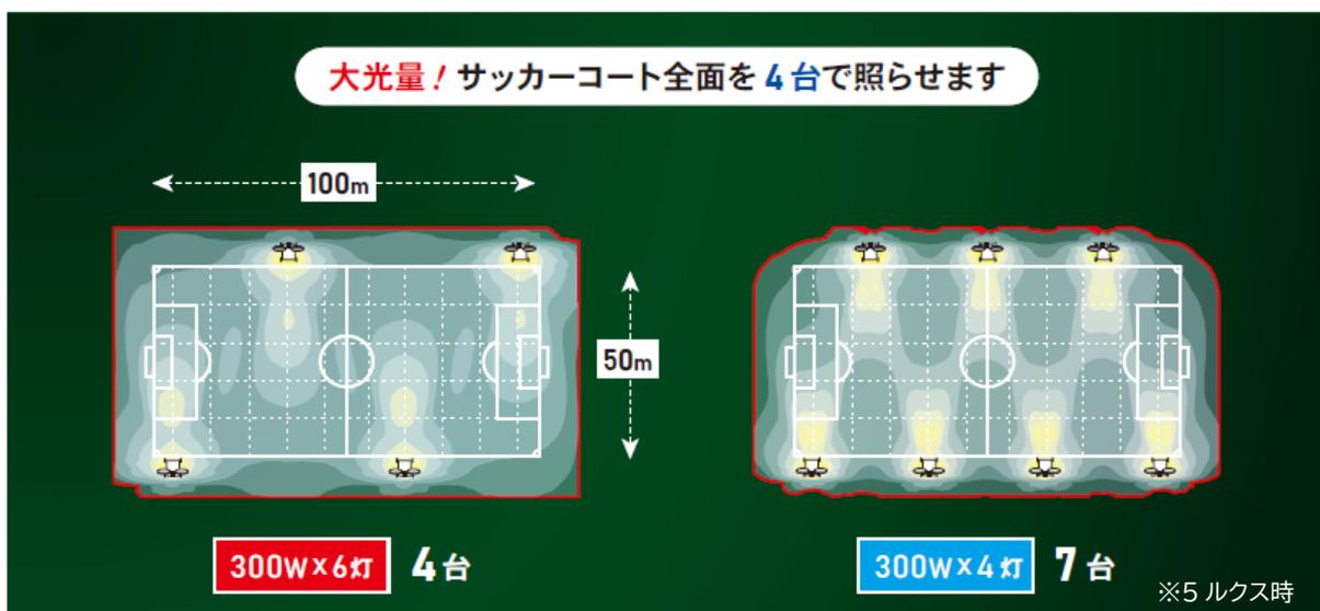
■「LED 投光機 6 灯式」照射面積(4 灯式との比較)
