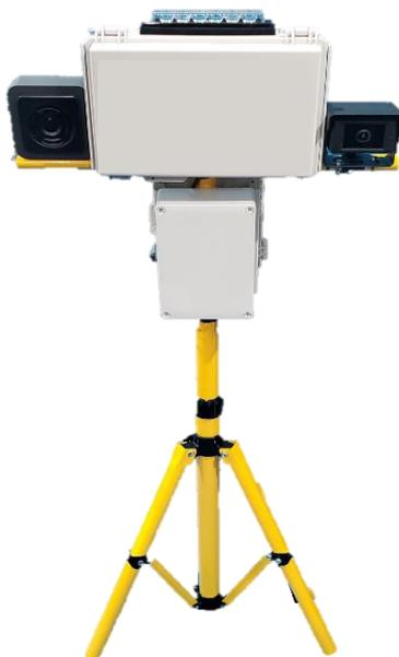
「アクティオ AI ボイス」は、AIカメラを使用して区画監視し、注意喚起するシステムです。建設現場などの立入禁止区域に人物を検知すると、機械上部のライトが点灯し、スピーカーから注意を促す音声流れます。音声は 4 種類あり、用途に合わせてスイッチで変更が可能です。
