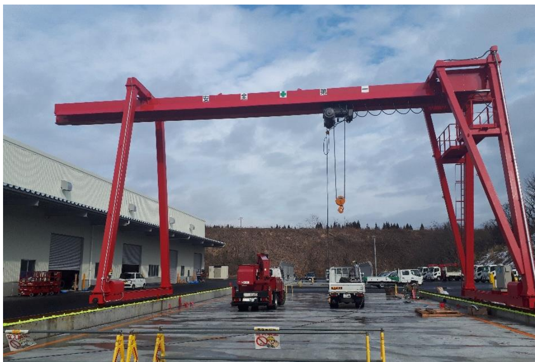
「橋形クレーン」
