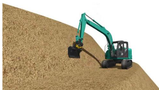
施工面との距離が保てない急傾斜地の 作業でも効率良く作業が可能
