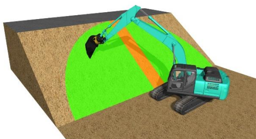
従来機よりも作業範囲が広い 緑:チルトローテータ オレンジ:従来機
