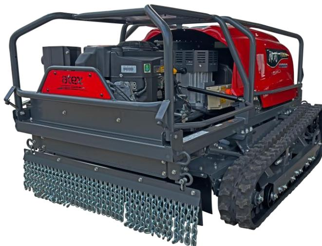
今回、レンタルを開始する「神刈 RJ1016」は、現在アクティオが取り扱う「神刈 RJ705」の大型モデルです。刈幅を 1,016mm に拡大し、従来機比で作業効率が 2 倍以上向上。より短時間で広範囲の草刈り作業が可能となり、業務の省力化に大きく貢献します。草刈りの機能はエンジン駆動、走行は電動でのハイブリッド仕様で、エンジン停止時でも最大約 25 分間の電動走行が可能のため、燃料を使い切っても自走で戻ってくるのが可能です。
