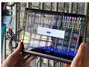
GeoMation AI 鉄筋出来形自動検測システム
