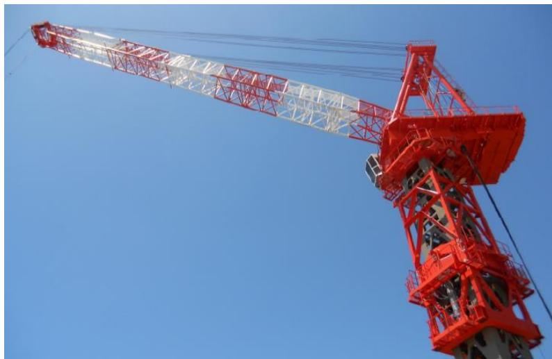
「パイロクレーン OTA-980HN」は、超高層大規模建築向けに設計されたタワークレーンです。最大定格荷重は 38t、最大定格時作業半径は 26m、最大揚程は 350m の高性能設計で、最大の特長は、タワー引込式独立型クライミング装置を採用している点です。通常のタワークライミング<sup>※1</sup>では、上面からタワーを取り込みますが、「パイロクレーン OTA-980HN」は、昇降体の側面からの取り込みが可能です。この装置により、自力でタワーを引き込みながら上昇(クライミング)することができます。
