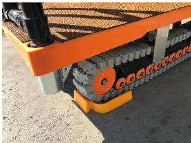
輪止めを完備
