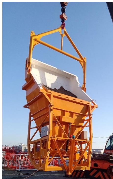
新型 5.0m 3 軽量水平式コンクリートバケット
