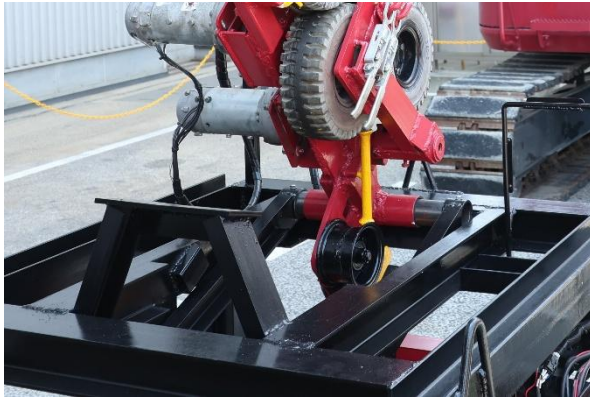
土台と駆動部本体がアームで連結され本体が吊り上げられる構造
