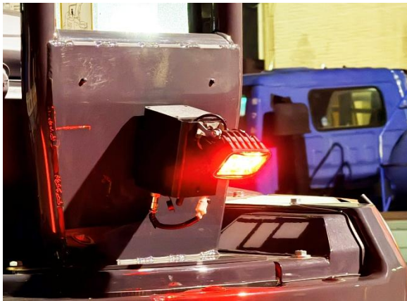
【重機後方に設置したマルビーム】
