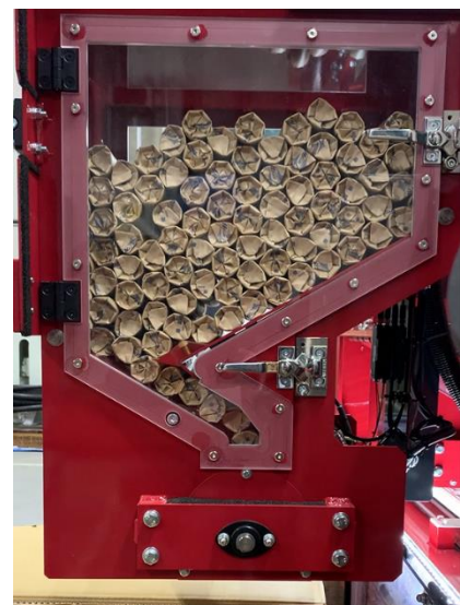
写真6 ホッパー内への爆薬格納状況
