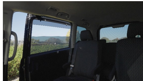
スライドドアの窓についている電子シェード 車内より撮影
