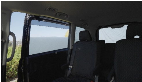
スライドドアの窓についている電子シェード 車内より撮影
