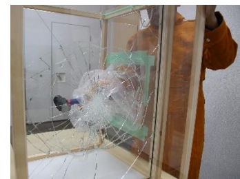
ダスキン サービスマスター事業による 「防犯フィルム」を貼ったガラスの強度実験 デモンストレーション風景
