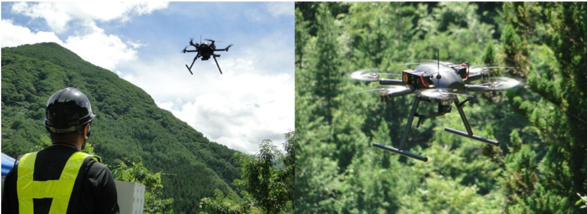
災害調査実施中のドローンの様子（写真はPF2によって実施した事例）
