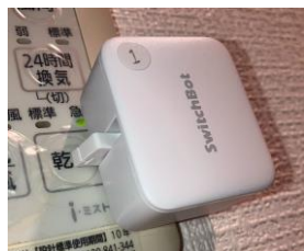
指ロボットが浴室乾燥機操作パネルのボタンを押す様子
