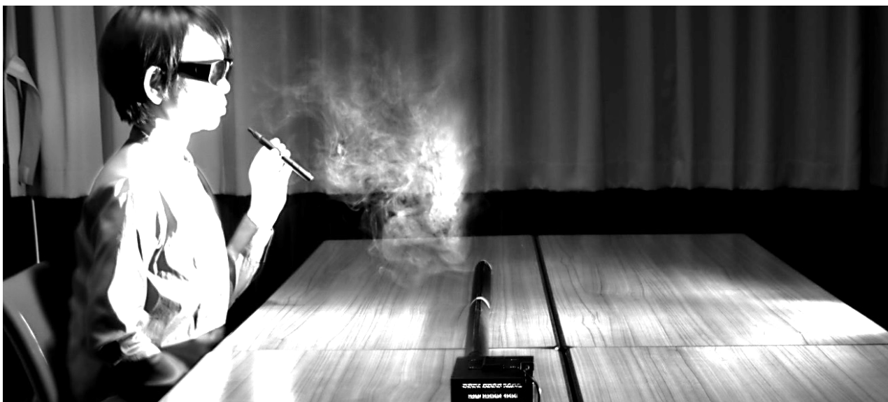
写真1: タバコの煙を用いた呼気の可視化実験(理化学研究所が開発した空気の可視化技術を利用)
