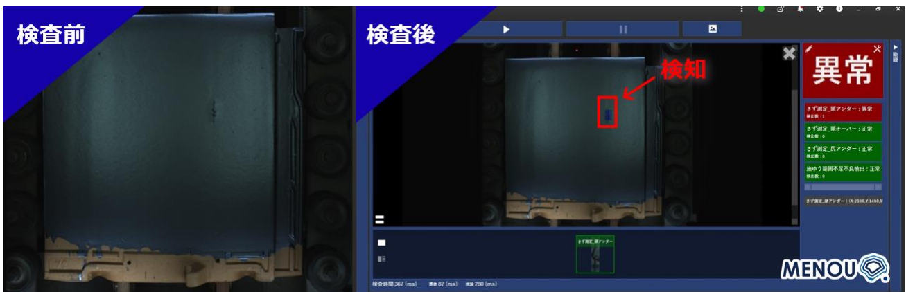
検査 AI MENUU によって、粘土瓦のキズを検知する様子
