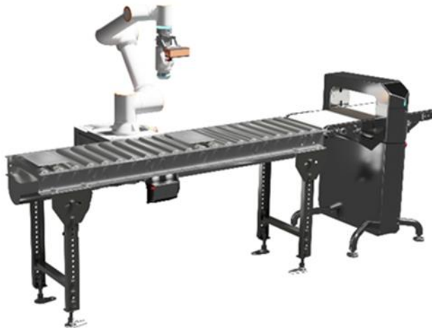
ダイナミック重量測定 by ZYXer®システム例。協働ロボットに力覚センサ、ビジョンセンサを搭載。
