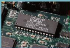
▶ ANTELOPE Trinity ICにLATTICEのFPGAが搭載されている ●はLXK PXC-TM144C
