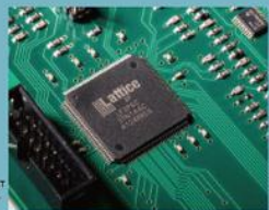
▶ ANTELOPE Trinity ICにLATTICEのFPGAが搭載されている ●はLXK PXC-TM144C
