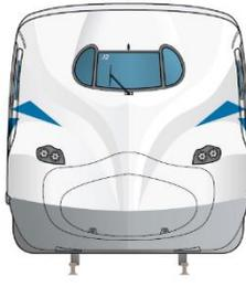
N700Sは、N700系の改良型です。N700系と比べると、ヘッドライトから車体にかけて、より膨らんだ形をしています。運転席の下の前部も違ってきます。
