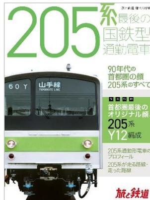
日本国有鉄道の分割民営化を目前にした1985年、軽量ステンレス車体、ボルスタレス台車、界磁添加励磁制御という新しい技術を採用した205系通勤形電車が、山手線でデビューしました。1987年の国鉄分割民営化後も、205系はJR東日本とJR西日本で増備が続けられ、特にJR東日本では横浜線、埼京線、京葉線などに新製投入され、まさに“首都圏の顔”として活躍をしました。2000年代に入り、新しい車両に交代が始まると、205系は短編成化改造をされて鶴見線、仙石線、八高線・川越線、日光線・東北本線などで新たな活躍を始めました。
