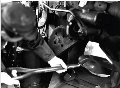
実車D51形で特異技、伏せシヨベルの要領をしてもらった。D51形は焚口を開くのに左足元にあるペダルを踏むので、両手でくべるシヨベルが使えた。中津川機関区にて
