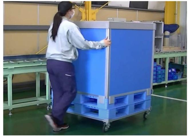
荷下ろしの際は、フォークリフトでちよいカーゴのパレット上に載せ（左）、そのまま手押しで移動（右）
