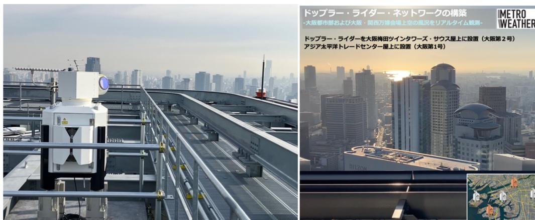
メトロウェザー株式会社（代表取締役社長：古本淳一、本社：京都府宇治市）は、ドローンや空飛ぶクルマが安全・安心に運航・離発着するための必須情報である突風や乱気流をリアルタイムに可視化する3次元風観測装置（ドップラー・ライダー）のネットワークを世界に先駆けて大阪ベイエリアおよび都市部、大阪・関西万博会場上空で進めています。
