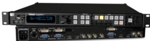
「ImageProシリーズ」の最新機種「ImagePro 4K」は、4Kでクリエイイトするための4Kスケール、コンバーター、スイッチャー機能をもった、イメージプロセッサー。2004年に発表した「Image PRO」の4K対応最新機種です。4K,4:4:4,60P,10bitの映像を遅延なくスケール、変換、切り替えができる。HDMI2.0、DP1.2、3G-12G SDIの各入力映像をシームレスに変換できる。他のバルコ製品と同様、高信頼設計で、ツアー等での移動や、複数回におよぶ設置・取り外しといった厳しい利用環境を前提に設計、テストされているため、大型コンサート、カンファレンスなどでも、故障なく利用できる。イベントを遂行するための入力信号なども、フロントパネルでを確認・把握できる。
