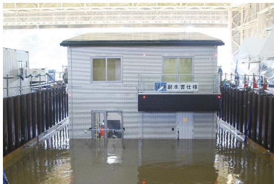
耐水害住宅「スタンダードタイプ」実大実験の様子
