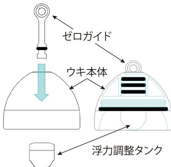
ゼロガイドを指で押さえながら浮力調整タンクを若干押し気味で時計回り約90度回して固定
