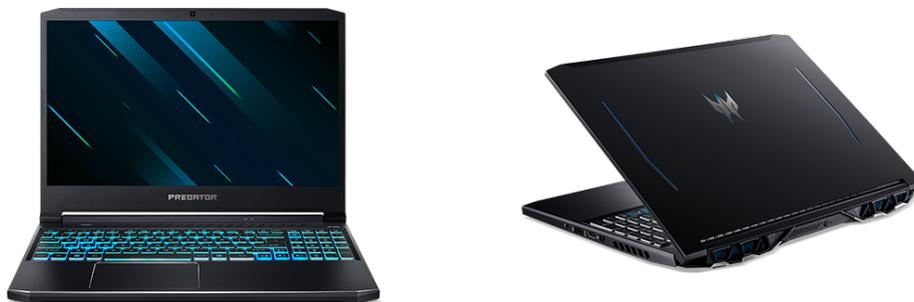
さらに、Acer独自の冷却システム AeroBlade™ (エアロブレード) 3D ファンテクノロジーを搭載。通常のファン1基に加えて、生体工学に基づき、静かで高速に飛行できるフクロウの羽からヒントを得て作られた、薄さわずか0.1mmのブレード59枚で構成された、第4世代 AeroBlade™ 3Dファンを1基配備しています。ファンのエッジをギザギザ状にすることで風量を増加させ、静音性を高めつつキーボード周辺の熱を効率的に排除します。
