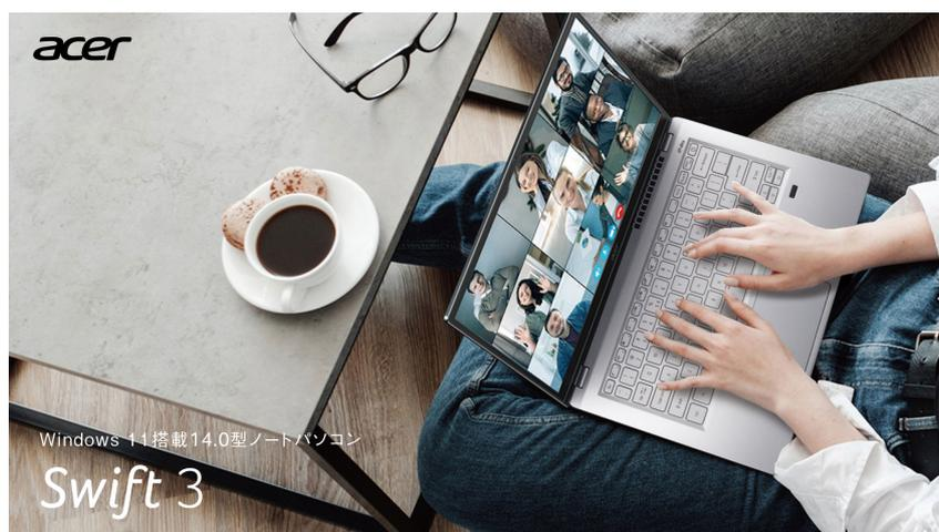
Swift 3「SF314-511-WF58Y/S」は、重さ約 1.3kg、厚さ 15.95mm とコンパクトで、筐体はオールメタルデザインを採用。本体カラーはシンプルで洗練されたピュアシルバーカラーに仕上げました。ディスプレイ対ボディ比は 85.73%と、ディスプレイを囲むベゼルを狭く設計しています。さらに、GPU は CPU 内蔵のインテル® Iris® Xe グラフィックスを採用しており、映像の編集などのクリエイティブワークやゲームなども快適に楽しむことができます。メモリは 8GB を備え、バッテリーの連続駆動時間は約 16 時間と外で作業したい方にも安心です。
