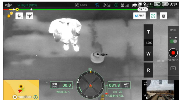
図 1: DJI 社 Matrice300 RTK に「OGI640」を搭載 図 2: プロパンガス可視化の様子(プロポ画面) (製品ページ: https://www.irsystem.com/product/ventus_ogi_for_uav/ )
