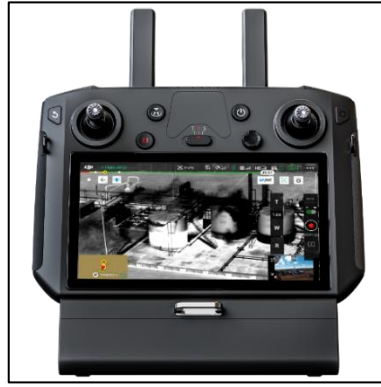
図 4: DJI 社製プロポにガスカメラ映像が映し出されている様子
