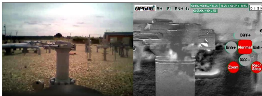
図3:左図は可視映像、右図がガス検知用カメラで撮影した映像
