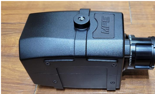
(左)ガス検知用カメラ「MFE OGI」 (右)歩行ロボット「SPOT」に搭載した様子 (製品ページ: https://www.irsystem.com/product/mfe_ogi/ )
