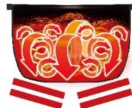
対角線上のヒーターで激しい対流を実現
