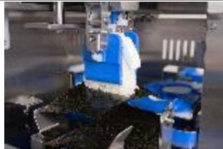
鈴茂器工が「寿司ロボット」や「ご飯盛り付けロボット」で培ってきたごはん一粒一粒を傷めることなく攪拌し、空気を抱くようパラパラと成形・計量する技術を継承しています。
