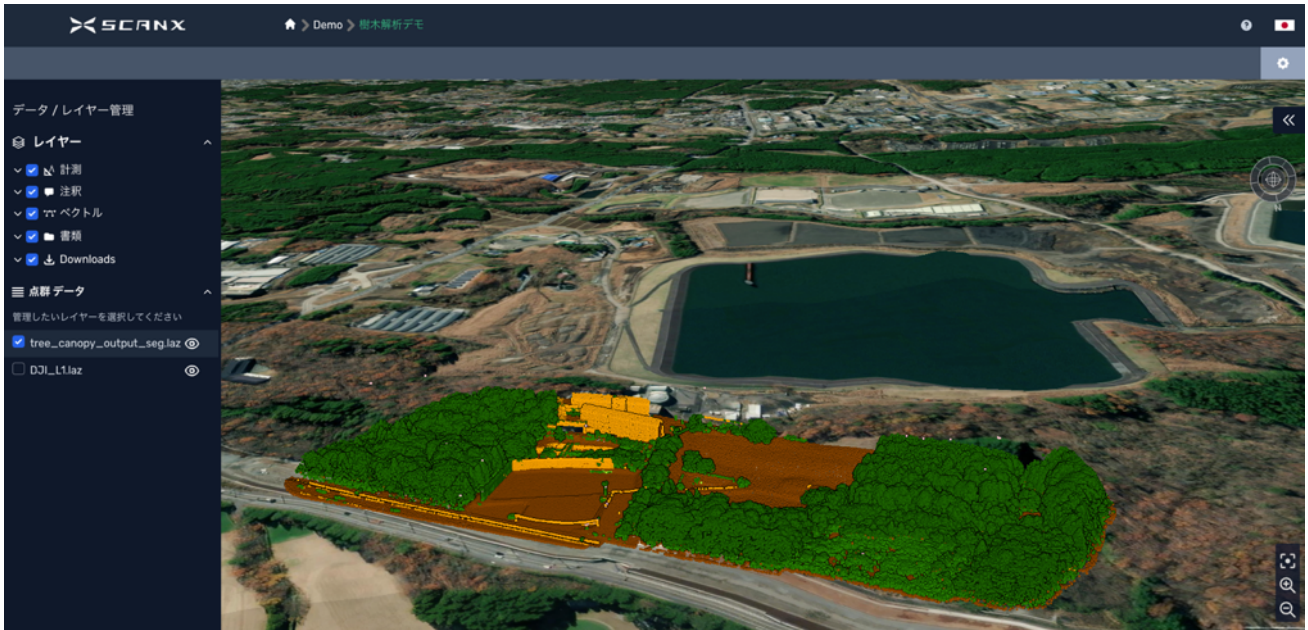
ScanX で自動分類した点群データ 緑：植生 オレンジ：人工構造物
