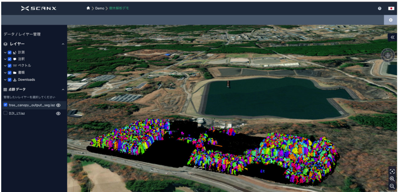
『樹木解析』により樹木 1 本ずつに色分けされた点群データ
