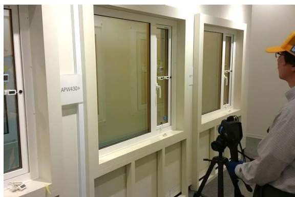
内観（断熱実験スペース）
