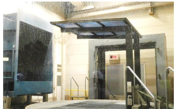
YKK AP 価値検証センターでの実風試験の様子
